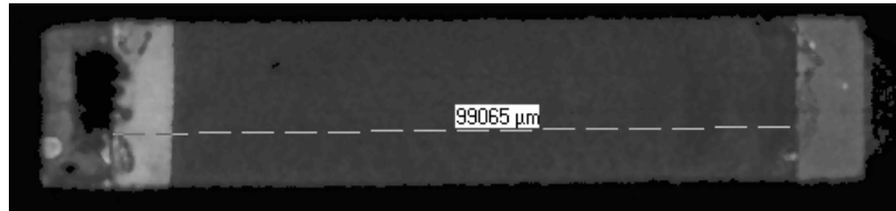
Figure 3 : Vue d'une éprouvette double poutre par microscope à ultrasons Ultrasonic Microscope view of a Double Cantilever Beam specimen
